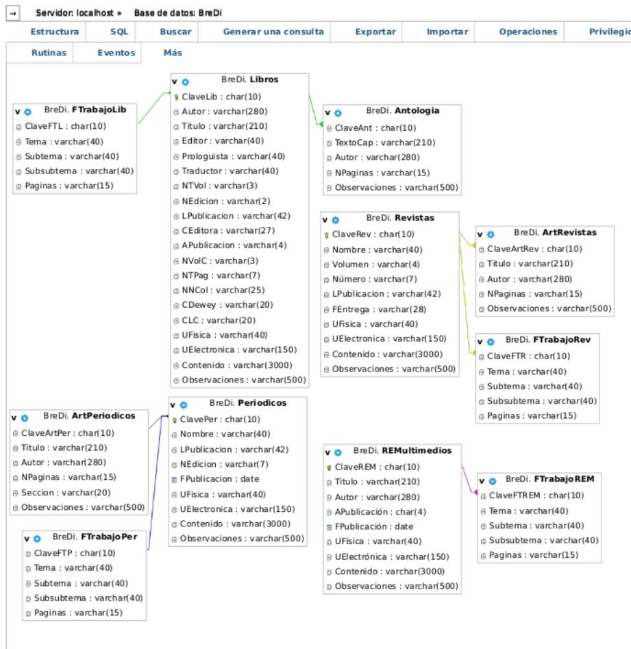
Figura 1: Primera versión del diseño de la Base de Datos del Sistema BreDi.
